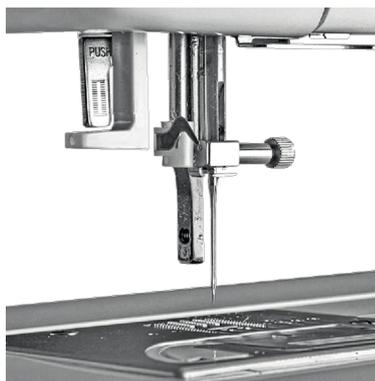
4. Entfernen Sie den Nähfuß-Halter und den Nähfuß.
