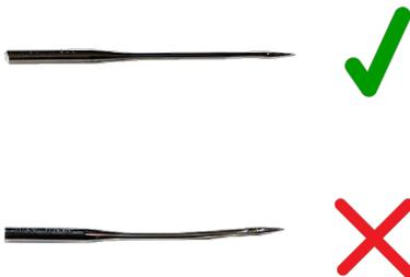
Sie können eine Nadel einfach überprüfen, ob sie verbogen ist. Legen Sie die Nadel auf eine plane Oberfläche wie z. B. auf die Nähmaschine oder auf die Stichplatte der Nähmaschine und prüfen sie von allen Seiten.
