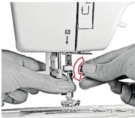
3. Lösen Sie die Halteschraube der Nadel, indem Sie die Schraube mit der Hand nach vorn zur Nase hin drehen.
