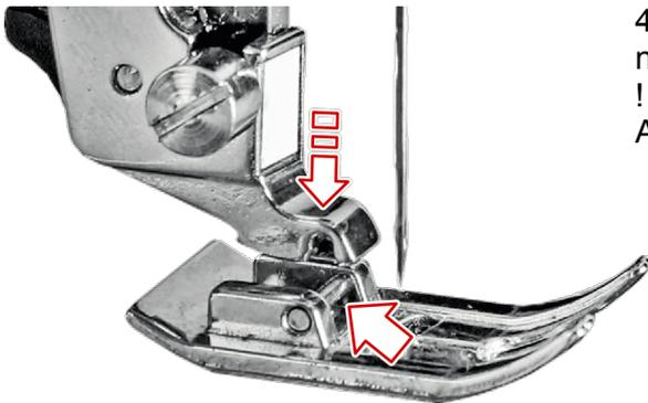
4. Setzen Sie den Nähfuß-Halter auf die Stegmitte des neuen Nähfußes.
