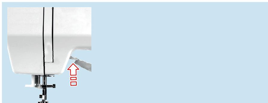
3. Schieben Sie den Verschluss der **«Spulenabdeckung»** nach rechts und entfernen Sie die Spulenabdeckung.
