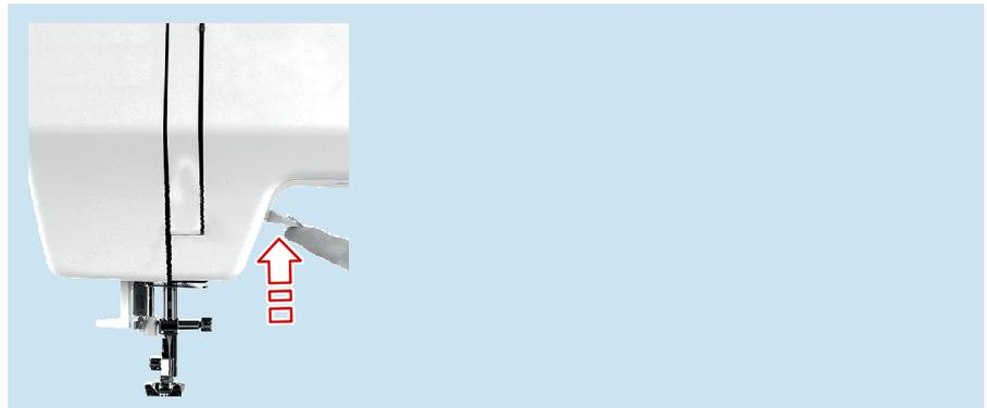
3. Schieben Sie zum Öffnen der Kunststoff-Greiferabdeckung den schwarzen Verschluss nach rechts und entfernen Sie die Greiferabdeckung.
