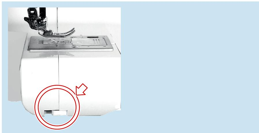
Lage des Hebels Zum Heben und Senken des Transporteurs
