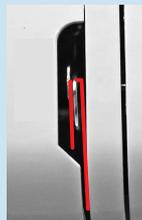
10. Haken Sie den Oberfaden weiterhin unter Spannung in die 4. Fadenführung (Fadenführungsclammer) ein und fädeln ihn in der 5. Fadenführung durchs Nadelöhr.
