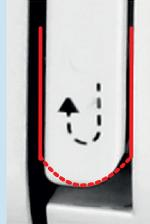
9. Fädeln Sie den Oberfaden weiterhin unter Spannung durch die 3. Fadenführung um den verdeckte <b>Fadengeber</b>.
