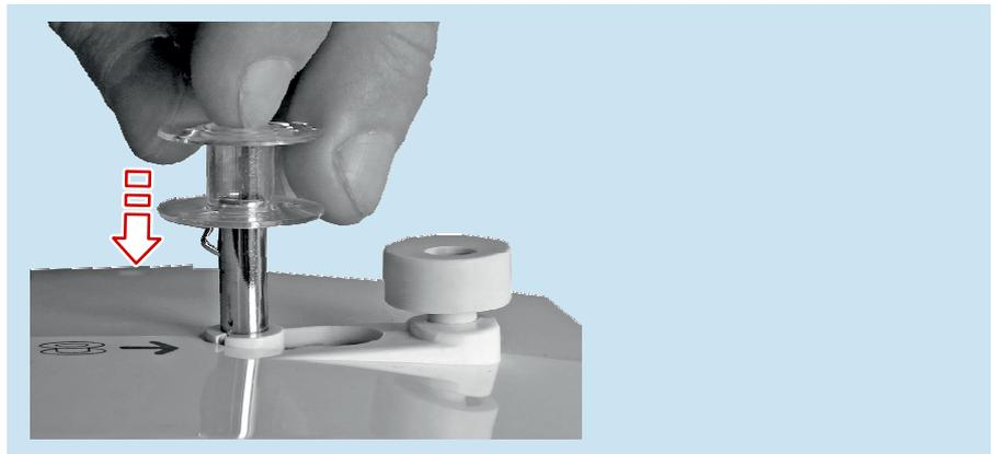
8. Drücken Sie die «Spulerwelle» mit «Spule» nach rechts gegen den Stop-
