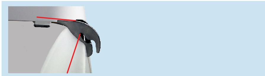
5. Führen Sie den Faden weiter zum kleinen Metallhaken der Fadenführung zum Aufspulen der W6 Kunststoff-Unterfadenspule und wickeln ihn einmal vollständig herum.
