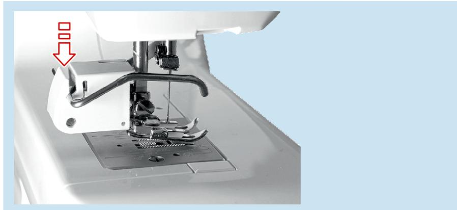
10. Prüfen Sie durch Drehen des **«Handrads»** nach vorn zur Nase hin, ob die Nadel mit der gewählten Sticheinstellung den **«Nähfuß»** nicht beschädigt.
