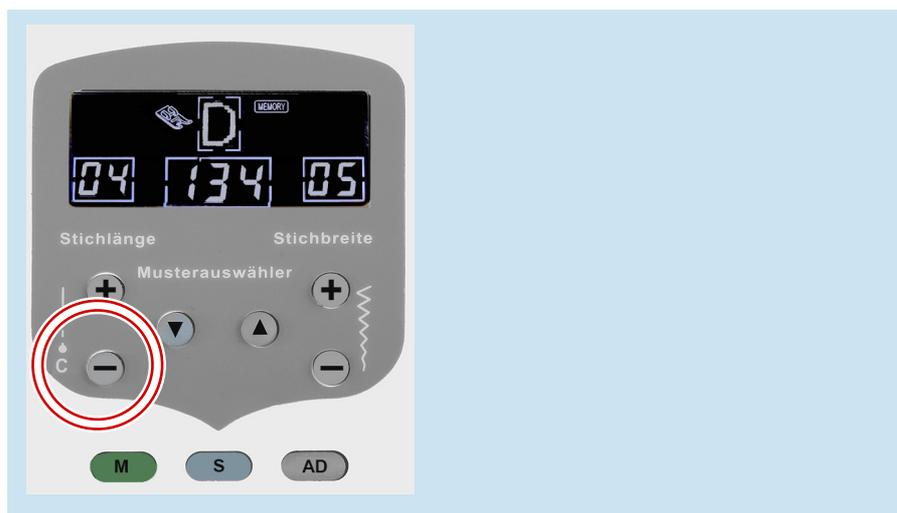
Anzeige der gespeicherten Werte mit der Taste (-) zum Verkürzen der Stichtlänge
