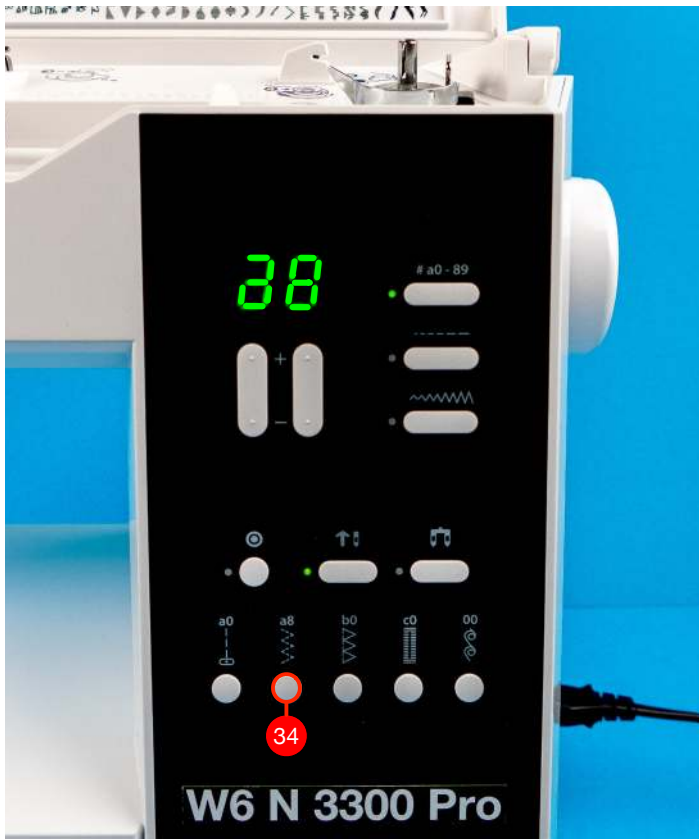
4. Drücken Sie die Gradstichschnellwahl Taste (34). Damit wählen Sie das Stichmuster Programm a8 aus. Das Bedienfeld sollte wie im Foto aussehen.
