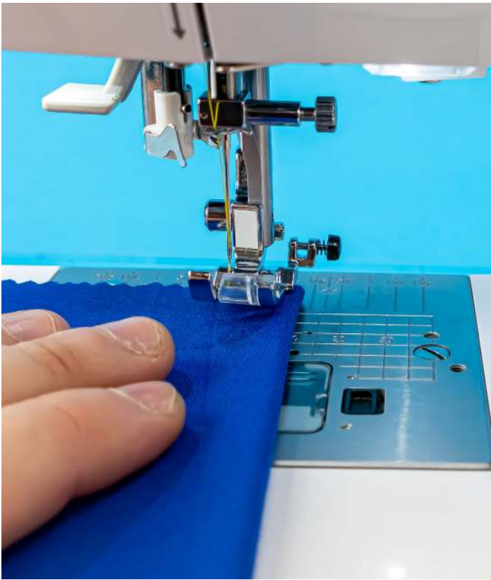
2. Legen Sie einen dehnbaren Stoff, den Sie zwingend doppelt legen, auf die Metallstichplatte der Maschine.
