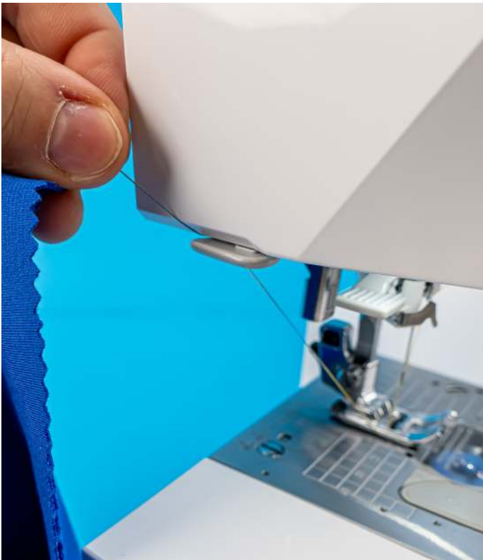
13. Ziehen Sie den Stoff vorsichtig heraus. Schneiden Sie den Ober- und Unterfaden mithilfe des Fadenabschneiders am Kopfdeckel der Maschine ab.
