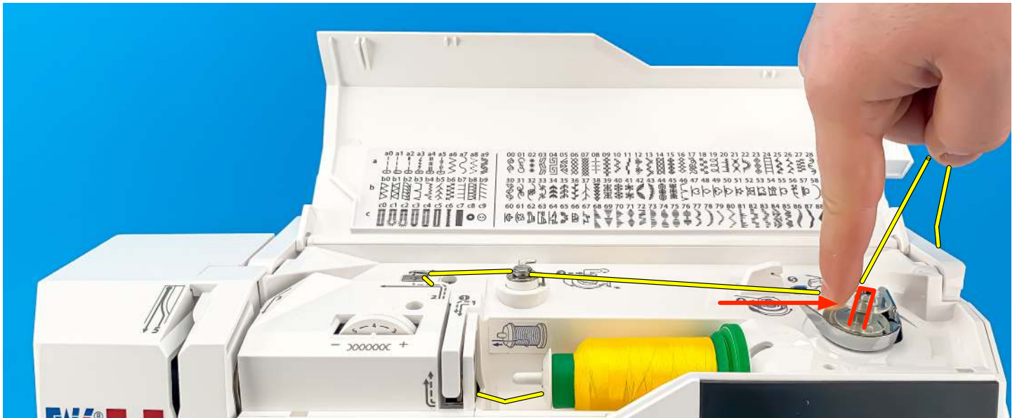
14. Drücken Sie die Spulervelle mit der W6 Kunststoffspule gefühlvoll nach rechts gegen den Stopper der Spulervelle. Halten Sie den Faden mit der anderen Hand fest.
