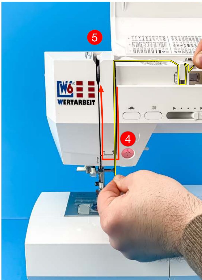
13. Ziehen Sie den Oberfaden weiterhin unter Spannung nach unten in Richtung Ziffer 4 und ohne Unterbrechung der aufgebauten Spannung nach oben zur Ziffer 5.
