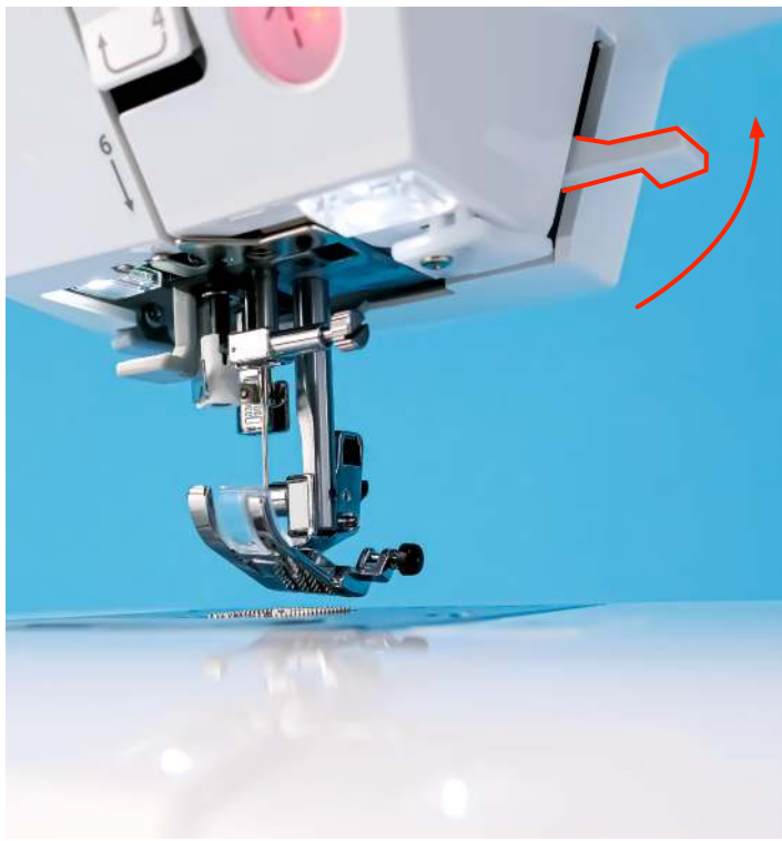
2. Stellen Sie den Lüfterhebel nach oben. Der Nähfuß rastet in der oberen Position ein.
