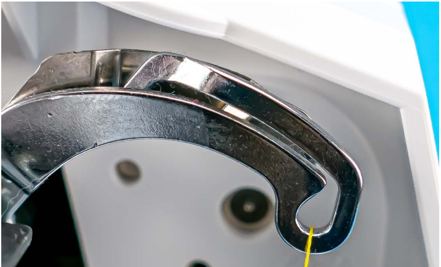
14. Ziehen Sie den Oberfaden weiter unter Spannung von rechts nach links vorne um den sichtbaren Metall Fadengeber (Ziffer 5). Ziehen Sie den Oberfaden weiter unter Spannung in Richtung der Ziffer 6.
