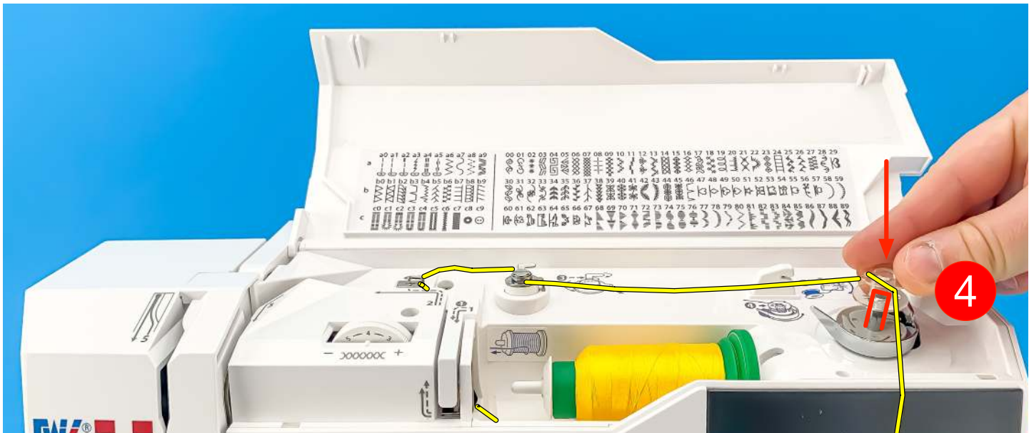
13. Stecken Sie die leere W6 Kunststoffspule auf die Spulervelle. (Ziffer 4) Die Spule muss hörbar auf der Spulervelle einrasten.
