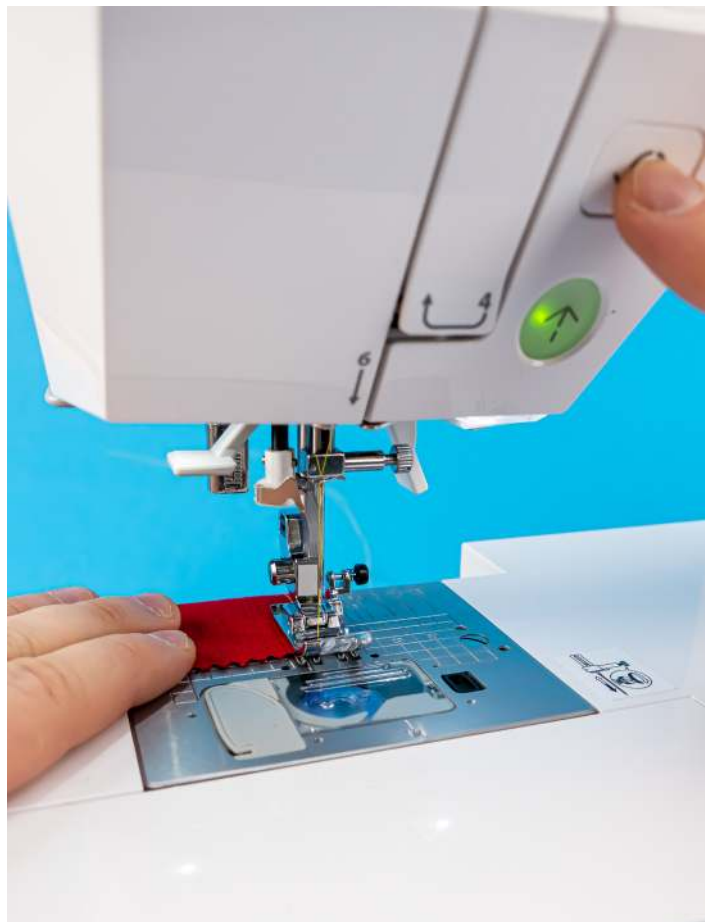
12. Zum Verriegeln des Nahtendes drücken Sie die Taste Rückwärts und halten Sie diese Position für zwei bis drei Rückwärtsstiche fest. Lassen Sie die Taste los.
