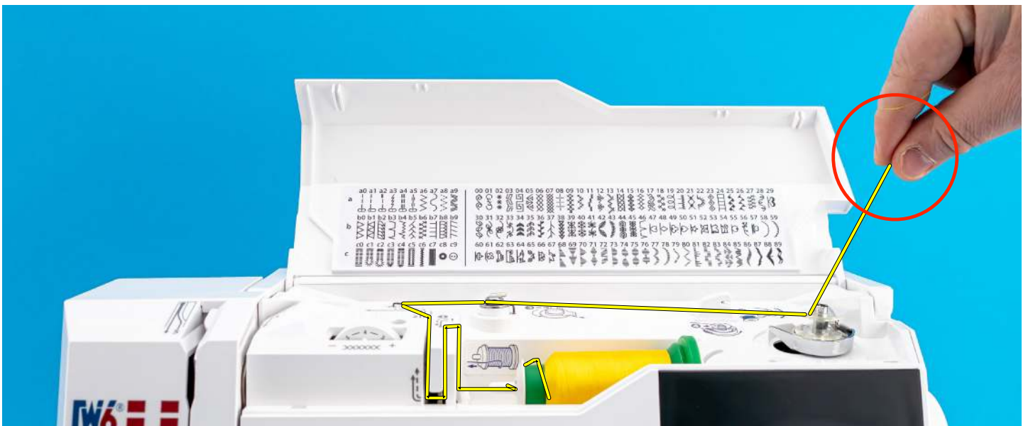
15. Halten Sie das Fadenende, dass Sie durch das Loch in der W6 Kunststoffspule gefädelt haben, fest.
