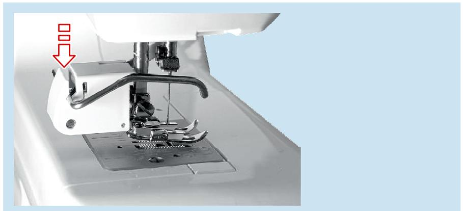
9. Prüfen Sie durch Drehen des **«Handrads»** nach vorn zur Nase hin, ob die Nadel mit der gewählten Sticheinstellung den **«Nähfuß»** nicht beschädigt.
