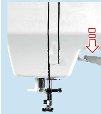
2. Drücken Sie den **«Nadeleinfädler-Hebel»** auf der linken Seite soweit wie möglich nach unten.
