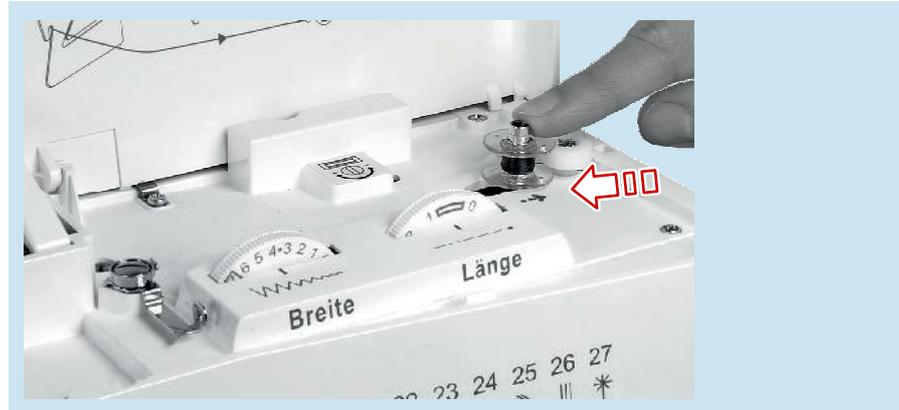
6. Schneiden Sie den Oberfaden ab, bevor Sie die **«Kunststoff-Unterfaden-Spule»** entnehmen.
