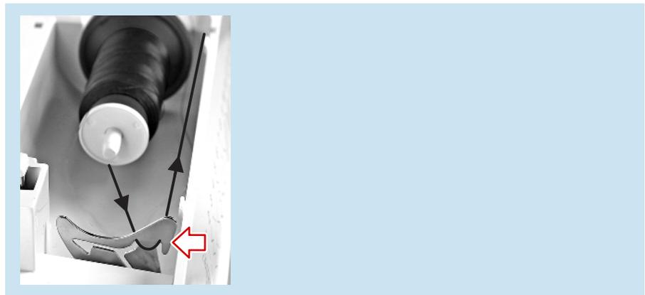
7. Führen Sie den Faden zurück vor der Garnrolle vorbei zum Haken vor der Aufspul-Spannungsscheibe.
