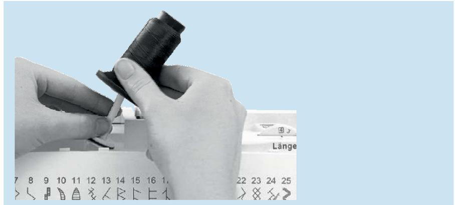
3. Sichern Sie die Garnrolle mit der Fadenabziehscheibe.
