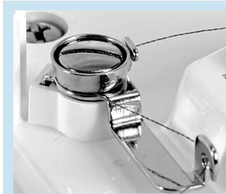
Faden 2 Mal um die Spannungsscheibe wickeln
