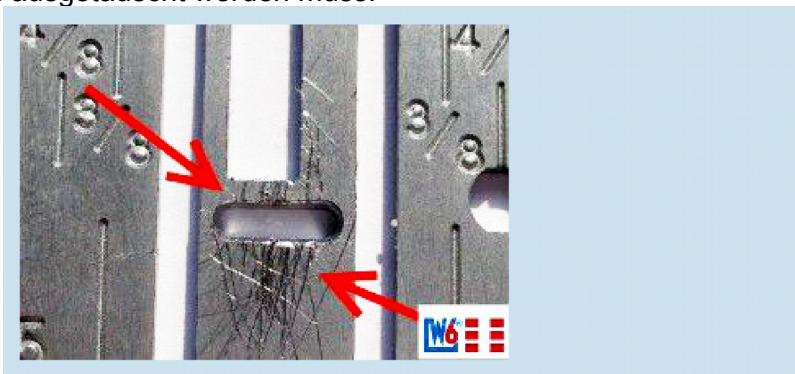
Stark beschädigte Stichplatte
