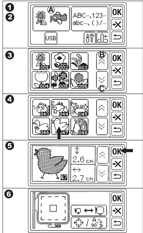
A. Wenn Sie das gewünschte Stickmuster ausgesucht haben, dann wird dies auf dem Display angezeigt. Auf der linken Seite des Bildschirms wird der Stickrahmen (B) und die Position des Musters (C) angezeigt. Sie können die Rahmengröße und das Layout des Musters von dieser Seite aus einstellen.
